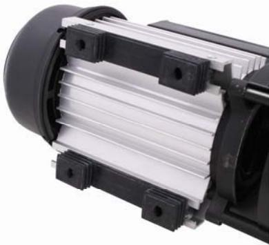
1. De let tilgængelige gummifødder tillader hurtig installering af pumpen. Man skruer 4 stk. M6 bolte op i de møtrikker, som er integreret i gummifødderne.
