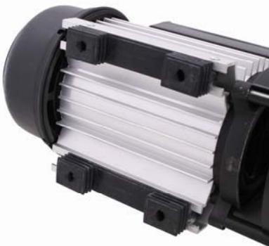
1. Die leicht-zugängliche Gummifüsse ermöglichen eine schnelle Installation der Pumpe. Die 4 Stck. M6 Bolzen werden in den Schraubenmutter in den Gummifüssen eingeschraubt
