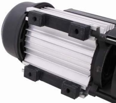
1. Les pieds en caoutchouc aisément accessibles permettent une installation rapide de la pompe en vissant 4 boulons M6 dans les écrous qui y sont intégrés.
