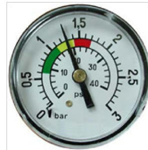
1,3 kg/cm 2 : Der Druck beträgt 0,5 kgs/cm 2 mehr als der Anfangsdruck. Das bedeutet, dass eine REINIGUNG notwendig ist
